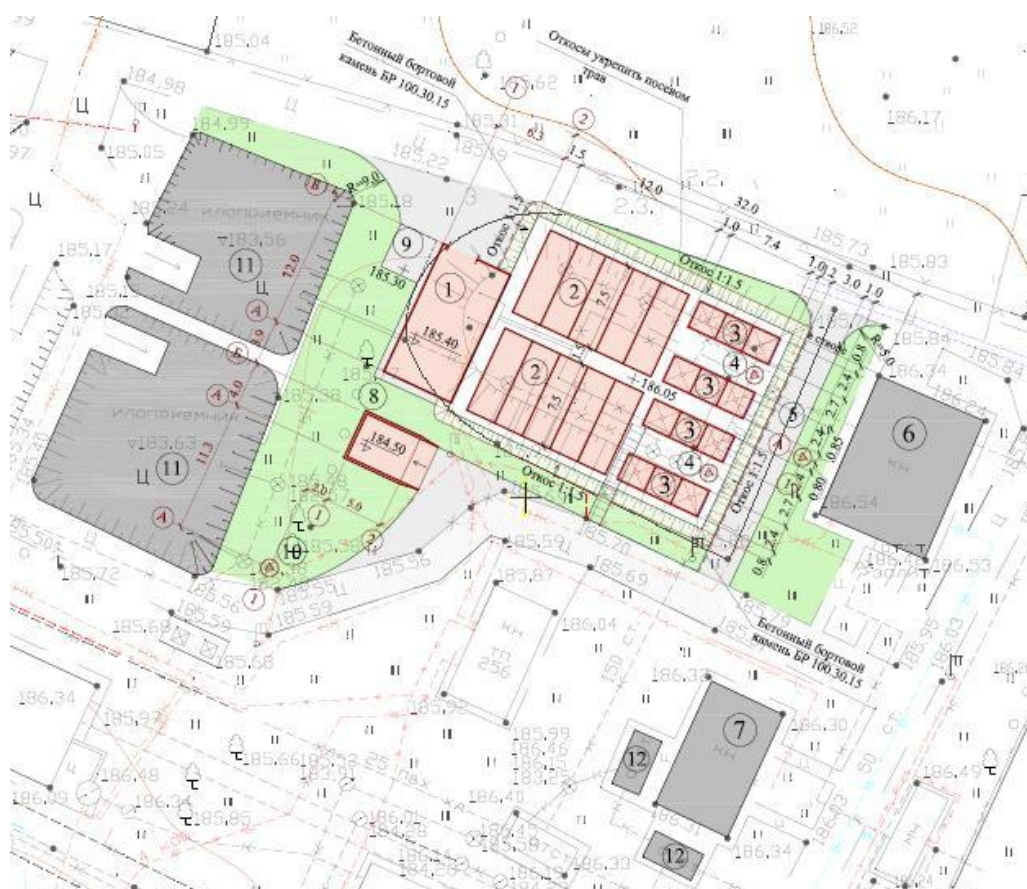
Рис.2 Генеральный план очистных сооружений после реконструкции
